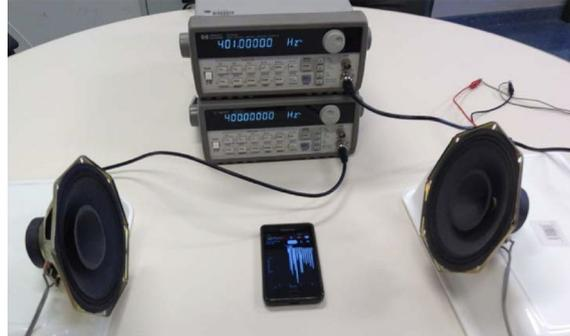
**Fig. 4.** Caracterización del batido acústico mediante el micrófono de un smartphone.
