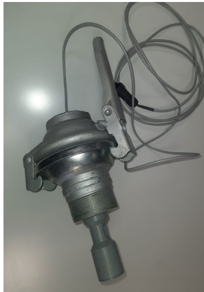
Figura 7. Conductímetro para instalar en la cuba de purín
