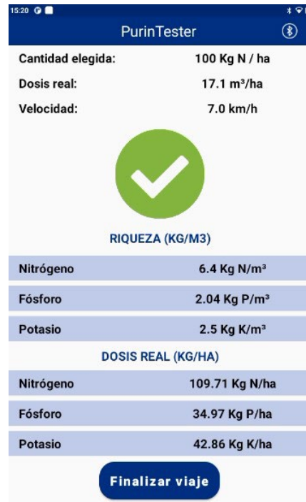
Figura 12. Imagen de la aplicación informática del conductímetro para la determinación de la velocidad del tractor y la dosis real de aplicación
