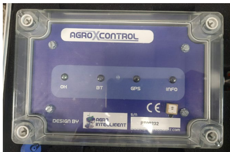
Figura 8. Equipo de toma de datos con conexión bluetooth y GPS
