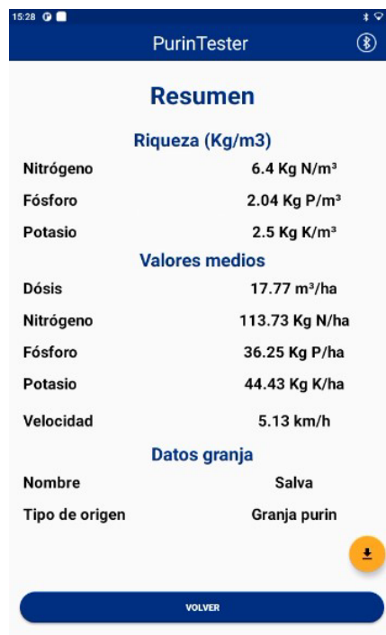
Figura 13. Resumen de los valores medios del purín obtenidos con la aplicación informática del conductímetro
