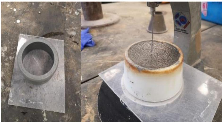
**Figura 28.** Molde tronco cónico normalizado (I).
