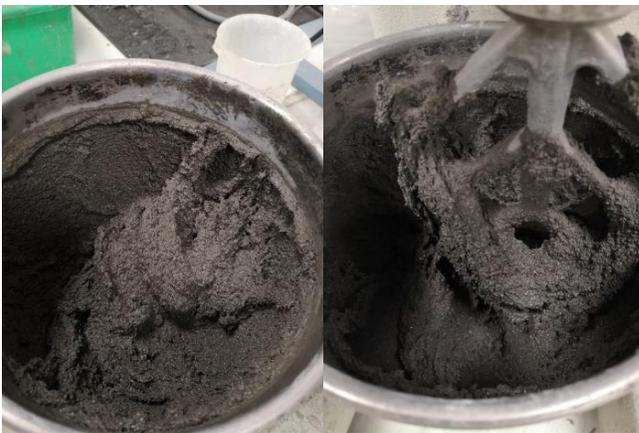
**Figura 60.** Muestras elaboradas con superplastificante VP-MC-Perma-71 (forma líquida).
