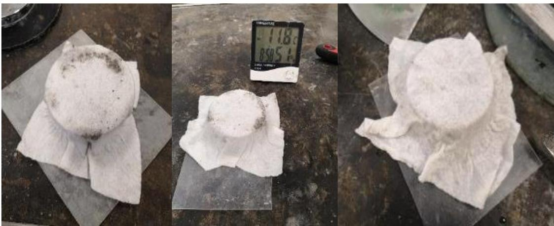
**Figura 20.** Protección de muestra con tela húmeda.
