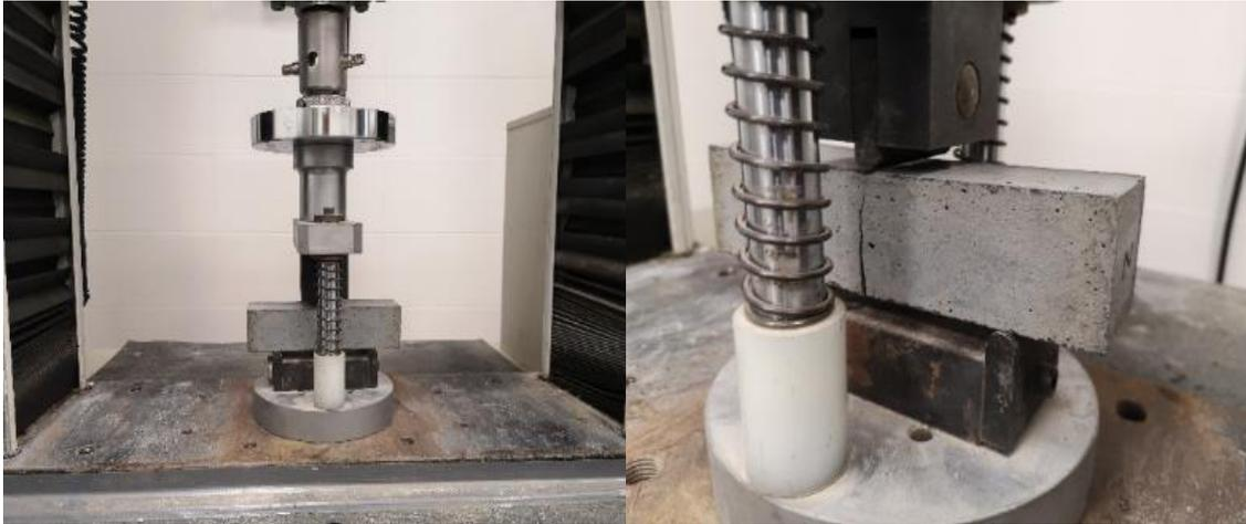
**Figura 23.** *Ensayo a flexión.*
