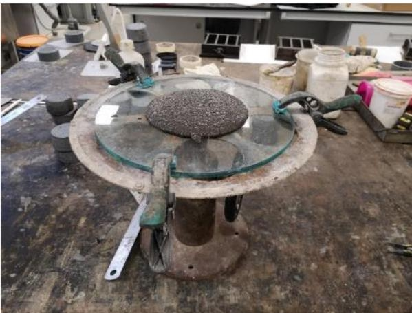
**Figura 13.** *Ensayos con amasado continuo y mesa de sacudidas.*
