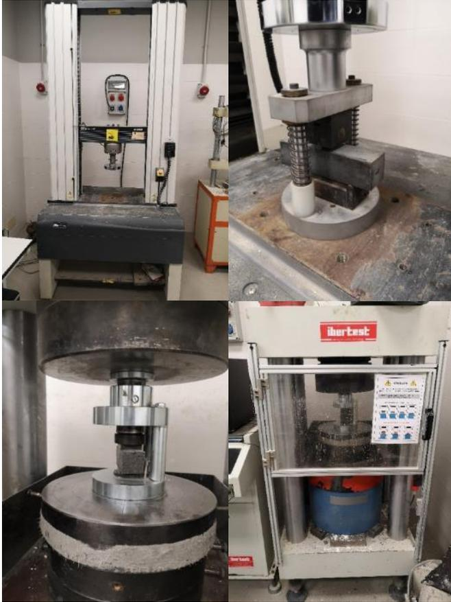
**Figura 32.** Prensa para ensayos de flexión y compresión.
